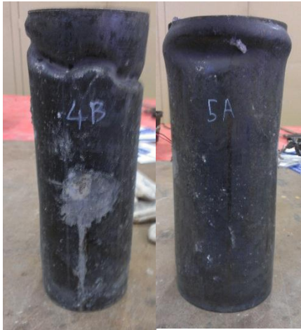
(d) Hollow D_s/t_s=101.6/3.2 (DSTC-8)
